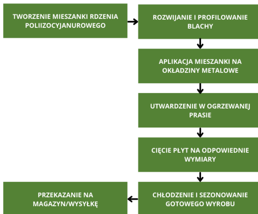
Rysunek 5.2: Schemat procesu produkcyjnego płyt warstwowych z rdzeniem PIR
